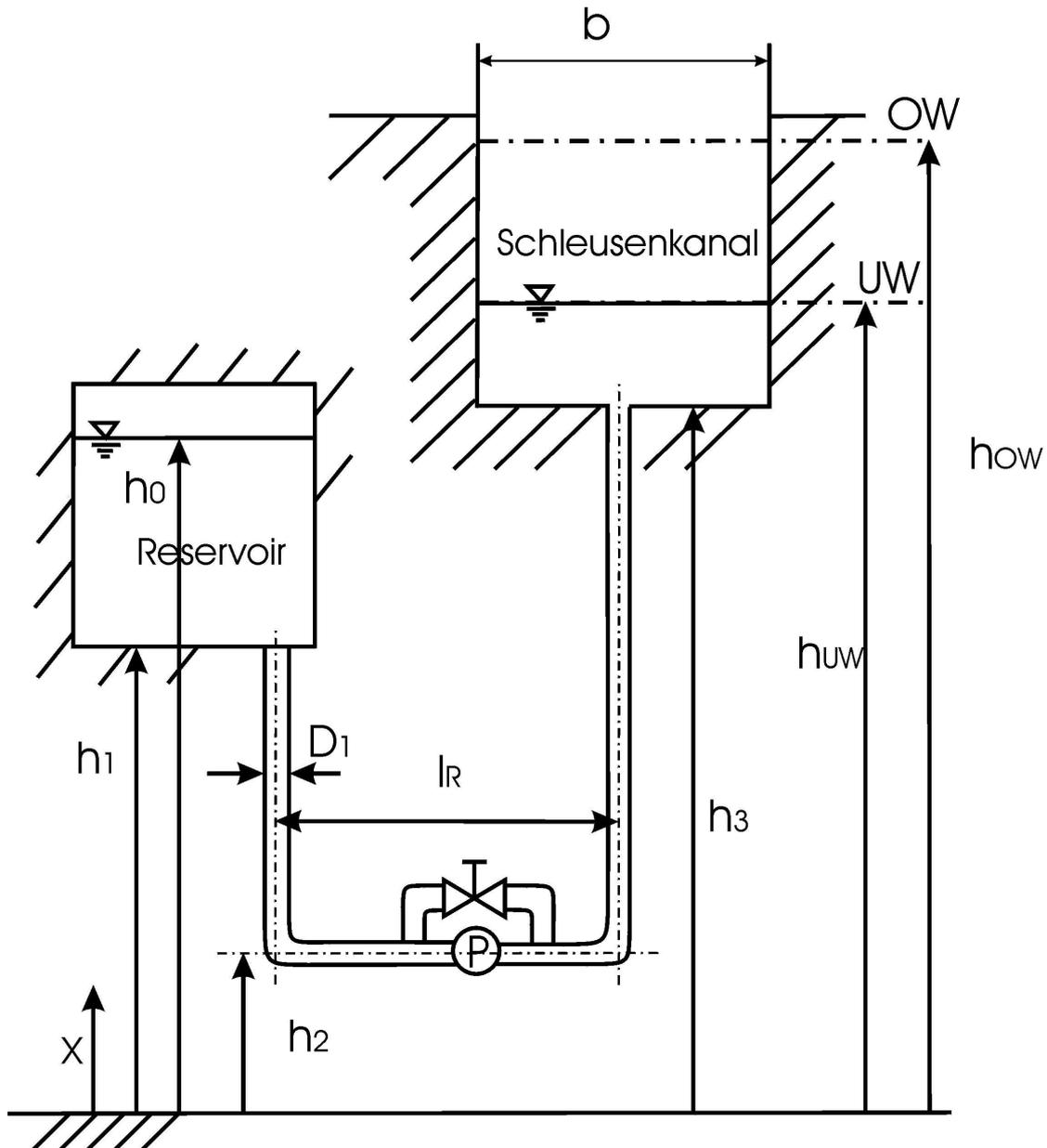
Das Wasser stehe zu Beginn im Unterwasser. Die vier Pumpen sollen den gleichen Massenstrom fördern und sind mit einem Wirkungsgrad von  $\eta=0,8$  dokumentiert.
