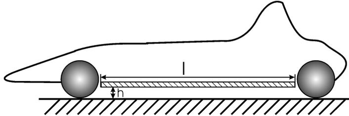
b1) Skizzieren Sie den Geschwindigkeitsverlauf zwischen dem Boden und der Platte und benennen Sie diese Strömungsart. Nehmen Sie an, die Strömung sei laminar. Bestimmen Sie den Wert der Wandschubspannung an der Platte sowie die Kraft, die aufgrund der Reibung auf das Auto wirkt. Randeffekte an der Platte seien vernachlässigt. (8 Punkte)
