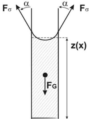
KGG in vertikaler Richtung an einem Scheibenelement der Dicke  $dx$ :
