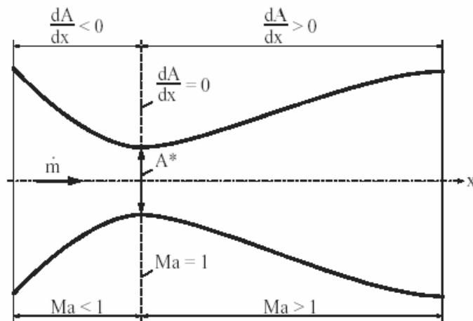
Die Lavaldüse dient dazu, eine Unterschallströmung auf Überschallgeschwindigkeit zu beschleunigen.
