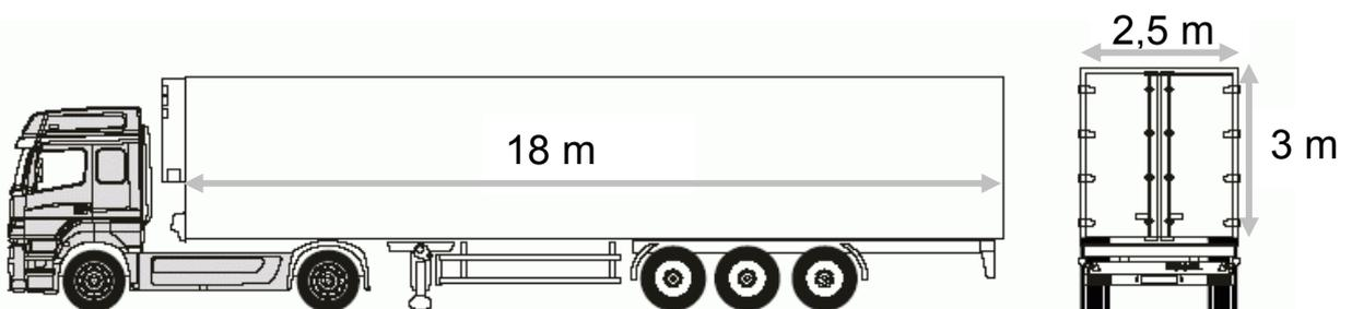
Gegeben:  $Re_{krit} = 8,6 \cdot 10^5$ ;  $l = 18 \text{ m}$ ;  $b = 2,5 \text{ m}$ ;  $h = 3 \text{ m}$ ;  $v_L = 15,3 \cdot 10^{-6} \text{ m}^2/\text{s}$ ;
