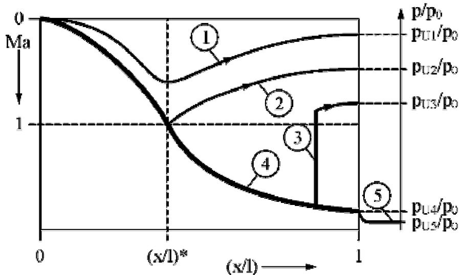
Der Druckverlauf im Auslegungspunkt entspricht Fall 4. Liegt der Umgebungsdruck noch unterhalb des Düsenaustrittsdruckes, kommt es hinter der Düse zu einer Nachexpansion des Fluids und damit zum Aufplatzen des austretenden Strahls.
