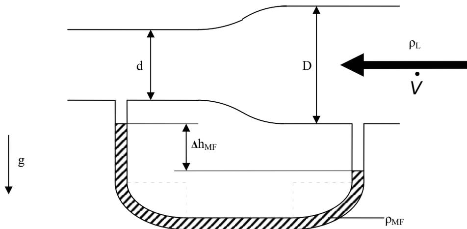
Gegeben:  $D = 0,5 \text{ m}$ ;  $d = 0,3 \text{ m}$ ;  $\Delta h_{MF} = 10 \text{ mm}$ ;  $\rho_{MF} = 13645 \text{ kg/m}^3$ ;
