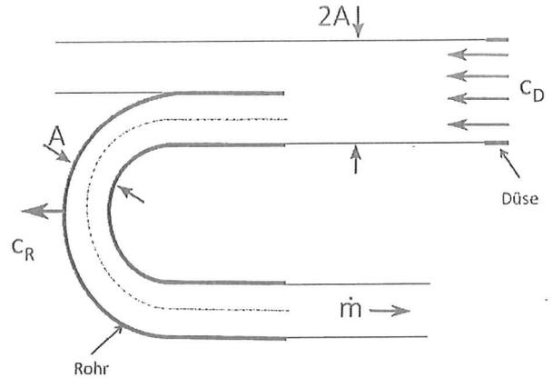
Abbildung 3: Umlenkung in einem bewegten Rohr
