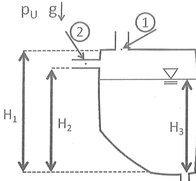
Abbildung 5: Scheibenwaschanlage (Ausschnitt Überlauf)
