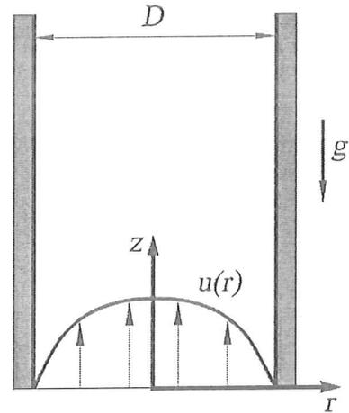
Abbildung 1: Rohrströmung nicht-Newton'sches Fluid
