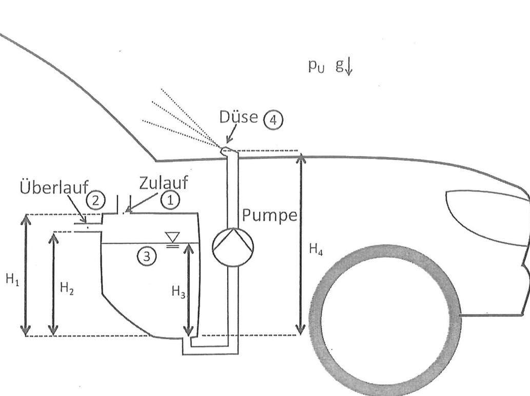
Abbildung 4: Scheibenwaschanlage eines Autos (Skizze)
