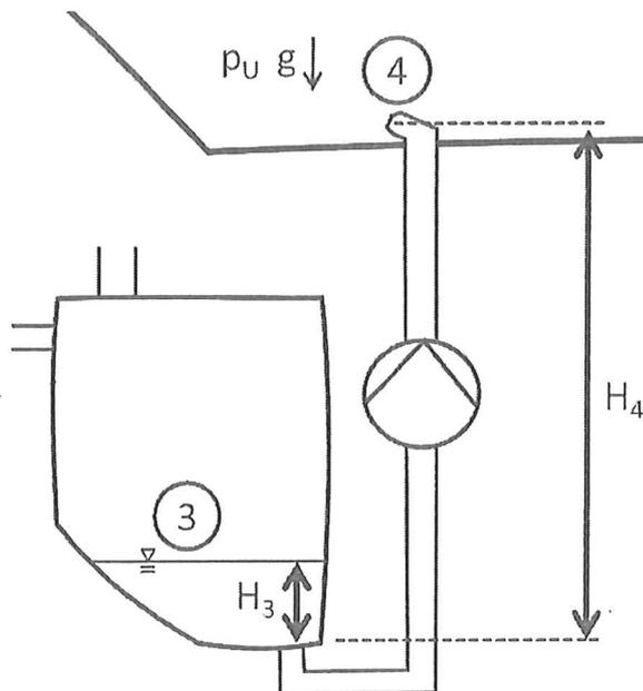
Abbildung 6: Scheibenwaschanlage (Ausschnitt Pumpe)
