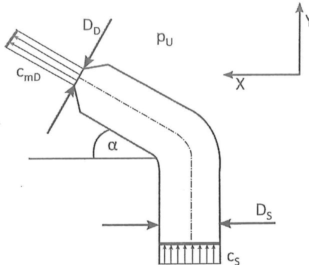
Abbildung 7: Düse der Scheibenwaschanlage
