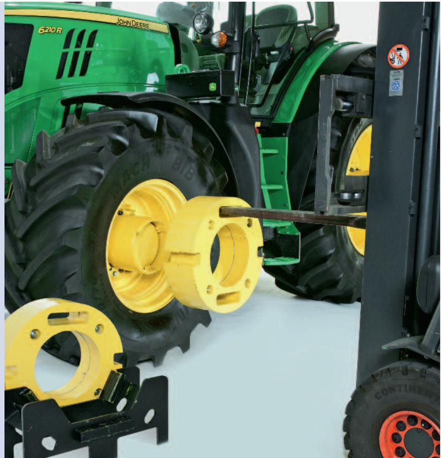
Flexibilität bei Gewichtsverteilung und Ballastierung von Traktoren sind in der Landwirtschaft wichtig, da Traktoren regelmäßig für verschiedene Feld- und Transportarbeiten eingesetzt werden. Durch richtige Ballastierung lassen sich die Traktion erhöhen und die Bodenverdichtung verringern.
