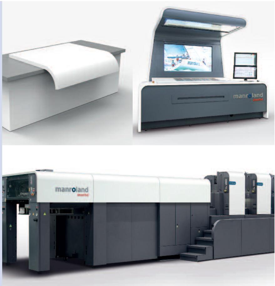
Die Roland 700 Evolution, entwickelt und produziert von der manroland sheetfed GmbH, ist eine der modernsten und effizientesten Druckmaschinen für den Bogen-Offset-Druck. Ihren Einsatz findet sie in erster Linie beim hochwertigen Verpackungs- und Akzidenzdruck.
