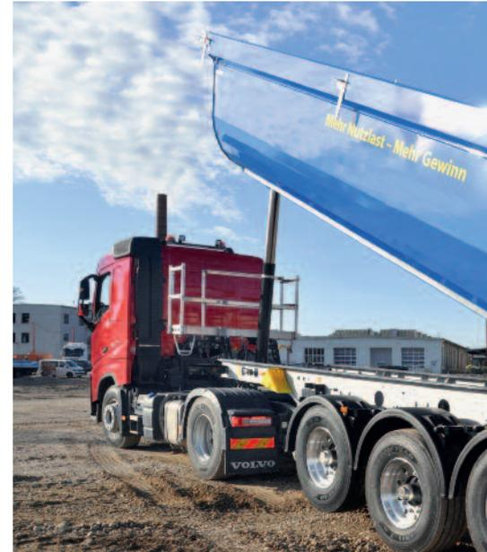
Sattelkipper sind erste Wahl, wenn es beim Schüttguttransport um hohe Produktivität geht. Sattelfahrzeuge haben weniger Bauteile, mehr Volumen und erhöhte Nutzlast, sie sind wendig und einfach zu handhaben.
